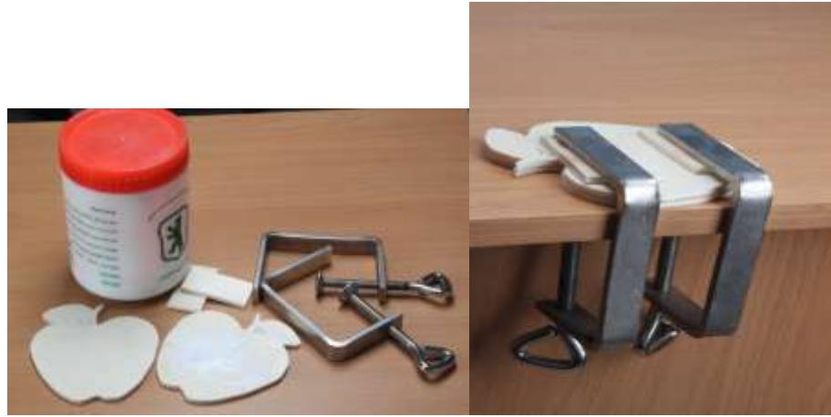
.6. شما می توانید پس از اره کاری ، سنباده کاری و در صورت نیاز سوراخ کاری و خراطی ، با کمک رنگ های گواش کاردستی های خود را رنگ آمیزی کنید و پس از خشک شدن رنگ ها به منظور تشییت رنگ آمیزی خود، روی قطعات اسپری جلا بزنید.
