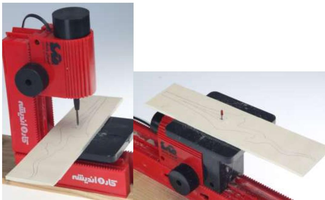
4 به منظور دسترسی به تمامی زوایای سطح قطعه کار، شما می توانید سنباده را از ریل جدا کنید و مطابق شکل زیر به صورت دستی به سنباده کاری بپردازید.
