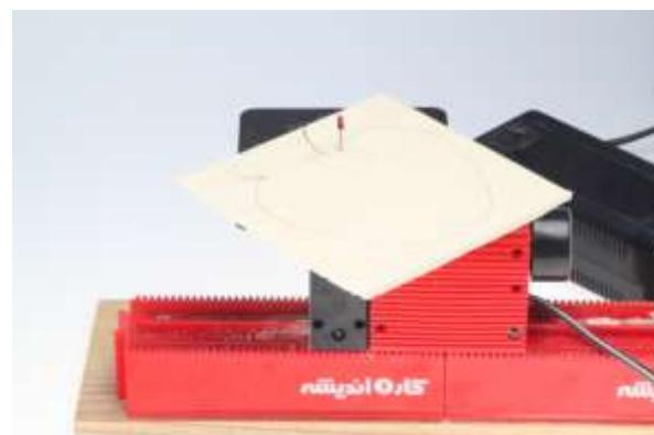
3 جهت بریدن سطوحی در داخل چوب ابتدا مطابق شکل زیر سوراخی در گوشه‌ای از محلی که قصد برش آن را دارید ایجاد نمایید و سپس دستگاه را در حالت برشکاری قرار داده و تیغه اره را در داخل آن قرار دهید و شروع به برش آن کنید.
